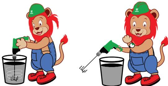
Trộn keo dán gạch Simba với nước sạch theo tỉ lệ như trên bằng máy trộn điện cầm tay với tốc độ chậm (160 vòng/phút) cho đến khi hỗn hợp đồng nhất.
