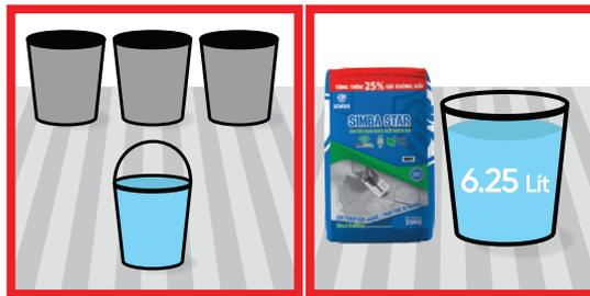
Trộn keo dán Simba bao 25 kg với 5.75 lít nước đến 6.25 lít nước hoặc 3 phần keo dán gạch Simba với 1 phần nước theo thể tích.
